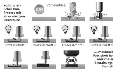
Prozessschritte im WIP-Verfahren
