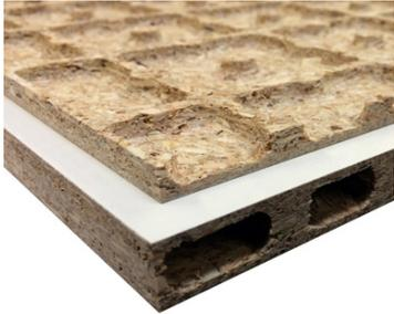
Particle Grid Board (Prototypen, 16 mm stark, Dichte nur 380 kg/m<sup>3</sup>)
