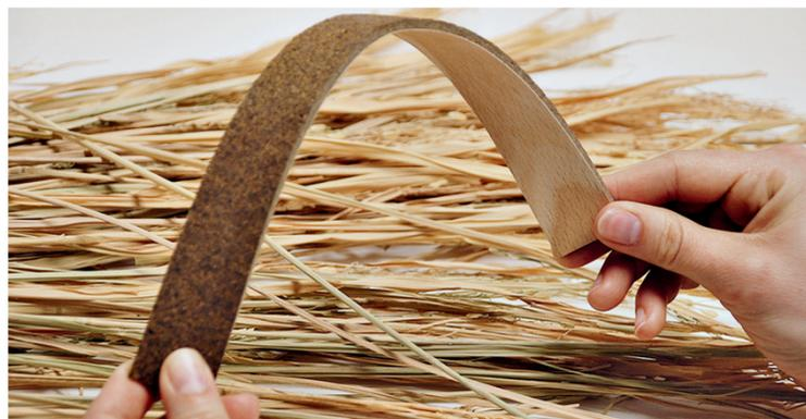
Die „Bioflexi“-HDF wird zu 80 bis 90% aus Stroh gefertigt.
