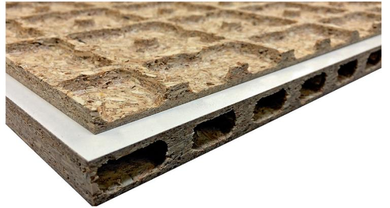
Gefertigt wird die neue Platte im kontinuierlichen Durchlaufverfahren unter Einsatz mitlaufender Formtableaus als Matrizen. An der Realisierung des Produktionskonzeptes für die Vorverdrichtung und -formung sowie den Schliff und die Melaminbeschichtung der Halbschalen arbeiten Kettler und Stosch seit geraumer Zeit zusammen mit einem Entwicklungsteam aus Partnerunternehmen der Holzwerkstoffindustrie und des Anlagenbaus.
