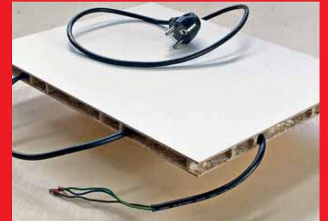
Je nach Kernstruktur bietet die „PGB“-Platte auch Verkabelungsmöglichkeiten in beide Richtungen
