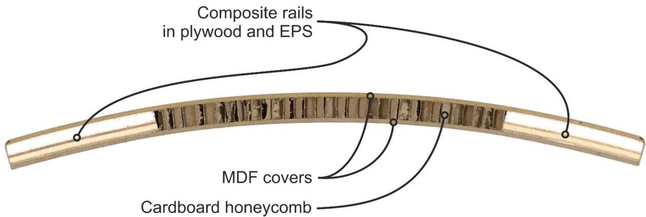
Vergleich Aufbau / Gewicht (Standard / Smart Weight) am Beispiel:
