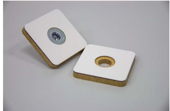
Abb. 2: Bohrloch mit Vorsenkung für den Flachkopf der Blindnietmutter
