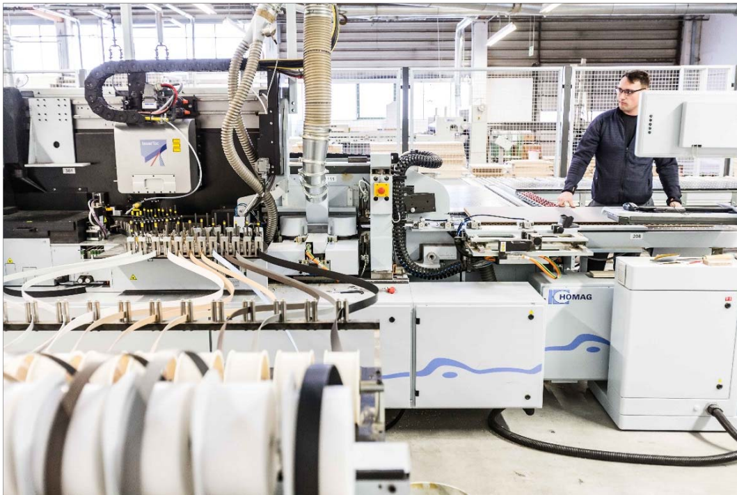
Abbildung 15: Homag Profiline KAL 310/9/A20 mit pneumatische angesteuerten Kapp- und Eckkopieraggregaten und Druckgurt, Verleim-Aggregat LaserTec 4,5W
