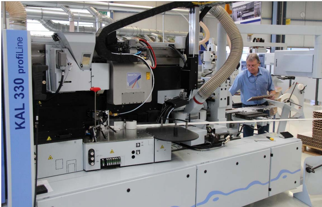
Abbildung 16: Homag Profiline KAL 330/9/A6/L mit servogesteuerten Kappaggregat und Druckgurt, Verleim-Aggregat LaserTec 4,5W
