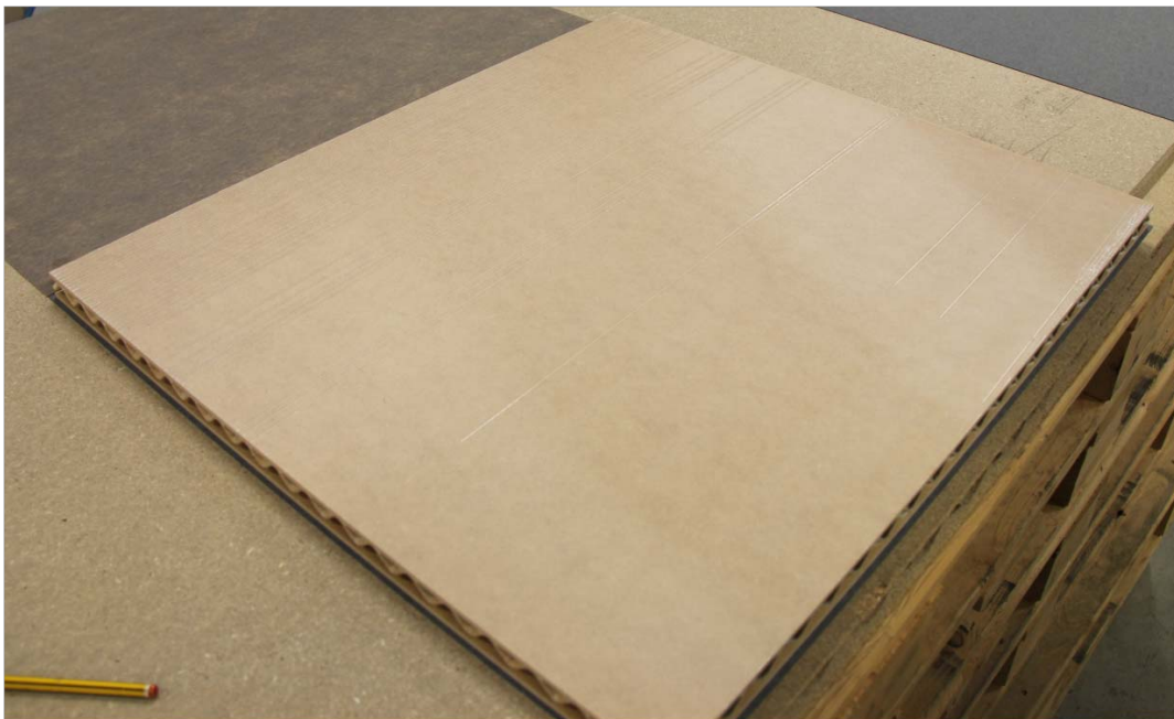
Abbildung 10: richtige Leimauftragsmenge 50 - 80 g/m 2 , zu empfehlen
