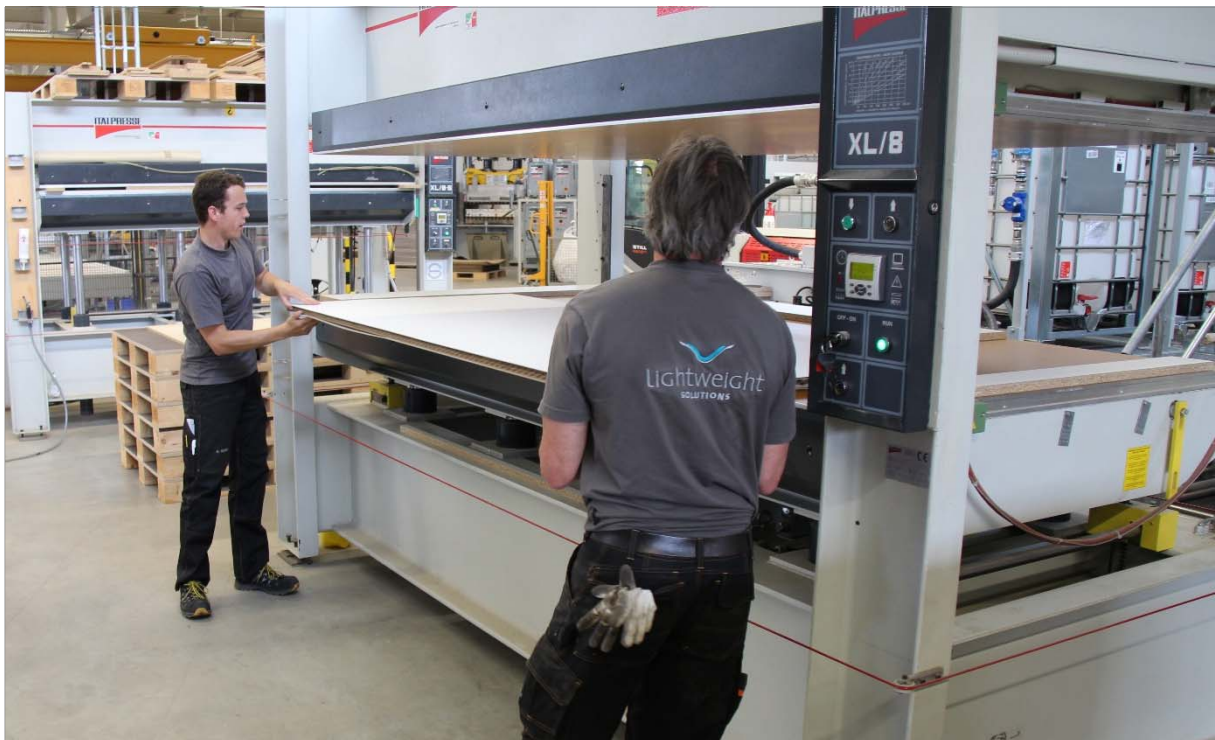
Abbildung 8: Oberflächenbeschichtung mit Schichtstoff in einer Kurztaktpresse
