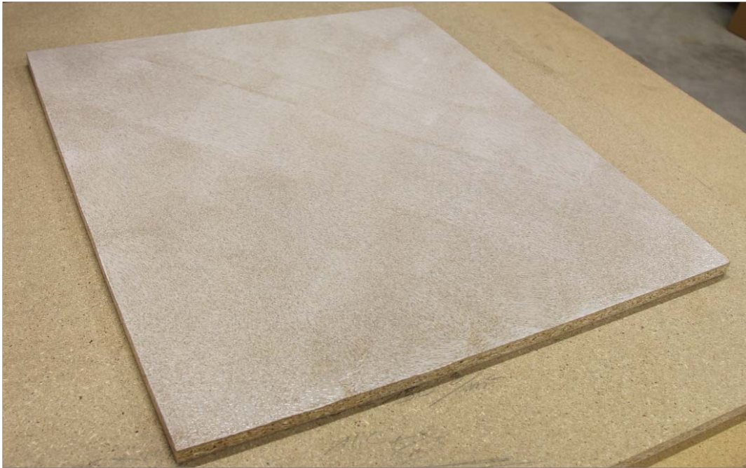
Abbildung 9: zu viel Leimauftragsmenge > 100 g/m 2 , nicht zu empfehlen
