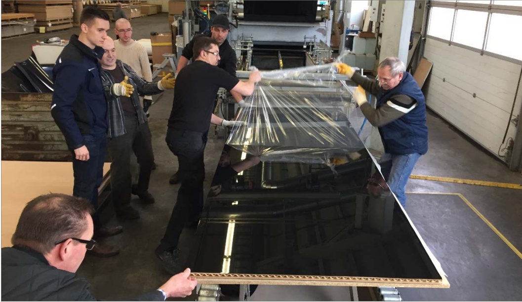
Abbildung 11: Rollenkaschieren mit SENOSAN® Hochglanz-Lack-Acryl-Folie von Senosan
