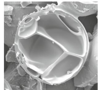
Die geschlossenzellige Struktur der Verolith®-Mikrohohlkugeln verhilft den Bauplatten zu einer geringen Wasseraufnahme und damit Frostsicherheit. Das macht sie universell einsetzbar – in allen Klimazonen.
