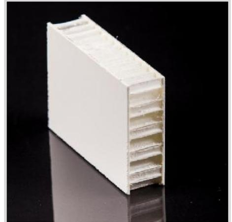
Die Kombination eines PP-Wabenkernes mit glasfaserverstärkten Deckschichten, die durch eine Gelcoatoberfläche ein nachträgliches Lackieren erübrigen, ergibt einen Sandwichverbund mit ausgezeichneten mechanischen Eigenschaften.
