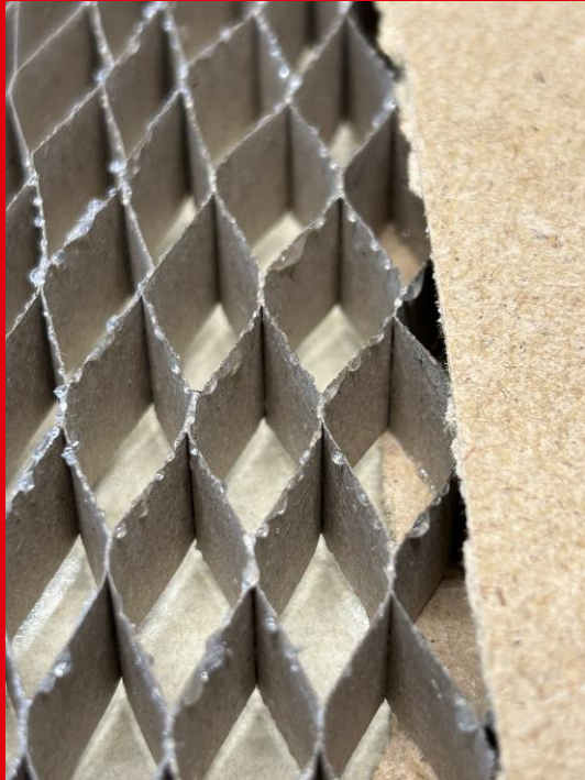
Auftrag mittels Hotmelt-Pistole direkt auf Wabe
