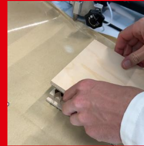
Auftrag mittels Hotmelt-Pistole direkt auf Wabe
