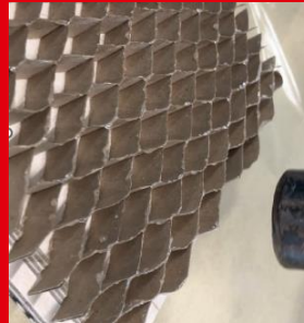
Reaktivierung durch Heißluft
