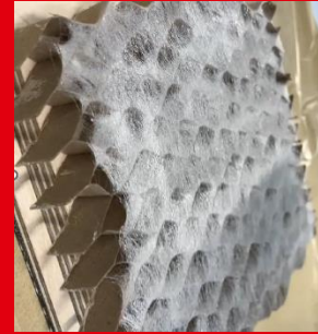
Auftrag mittels Hotmelt-Pistole direkt auf Wabe
