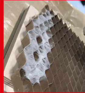
Auftrag mittels Hotmelt-Pistole direkt auf Wabe
