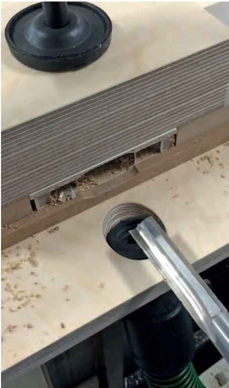
/ Fräsen der Wood-Insert-Ausnehmung an der konventionellen Langlochbohrmaschine.
